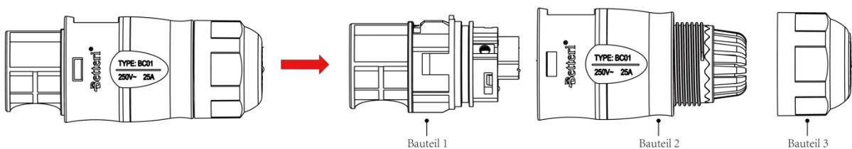
2. Führen Sie das AC-Kabel durch Bauteil 3 und Bauteil 2 und vervollständigen Sie die Verdrahtung von L, N und Erdung im Bauteil 1 des AC-Anschlusses wie im Bild unten dargestellt:
