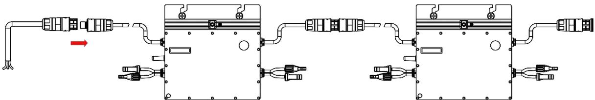
C) Schließen Sie die andere Seite des AC-Endkabels an den Verteilerkasten an und verbinden Sie es dadurch mit der hausinternen Installation.
