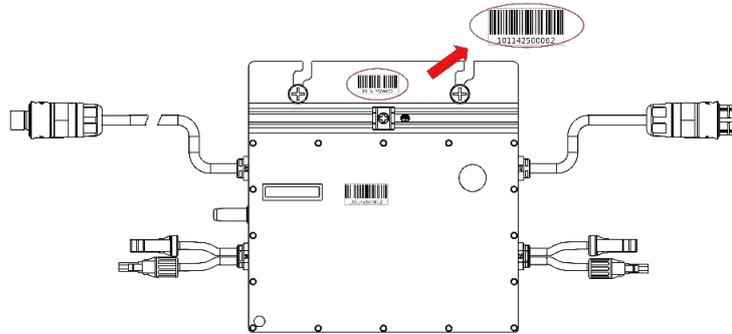
B) Bringen Sie das Seriennummertikett an der dementsprechenden Stelle in der Installationsskizze an.
